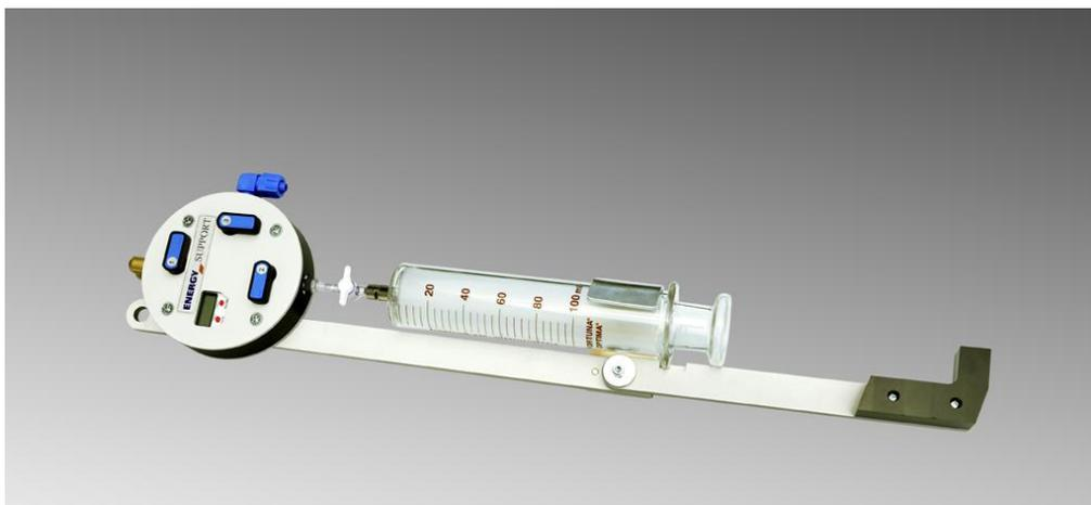
当前国际、国内通用标准均规定了标准的油中溶解气体全密封油样取样方法，从而可确保变压器油中溶解气体及各痕量组分的精确测定，而正确的取样也是确保油样不受污染的必要措施。根据 IEC567/ASTM3612/GB17623 标准专门开发的油浸式电力设备专用油样全密封取样装置套装完美地满足上述油样现场采集的要求。
