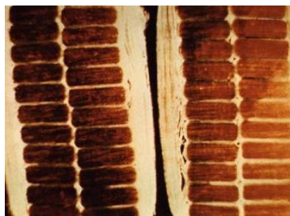
发电机定子线棒内空穴
