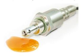
汽轮发电机组作为高速转动机械设备,其可靠性及稳定运行依赖于润滑系统的状态,尤其是润滑油油质的良好状态。迈射智能科技专门开发的新一代润滑油介质损耗在线变送器可实时反映润滑油油质的综合状况,变送器内嵌入式系统可直接给出设备润滑油状态参数,即与新油相比的油质状况以及污染程度等参量。基于发电机透平油介质损耗变送器的实时监测功能,用户可灵活安排发电机透平油介质更换,延长大型汽轮发电机线平油的使用周期,从而降低设备运行维护成本。
