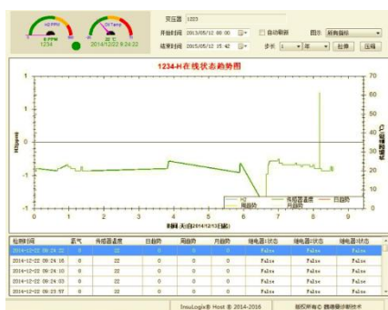
电缆油中溶解氢气浓度实时趋势显示
