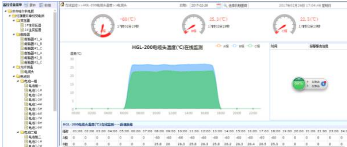
电缆接头温度在线监测
