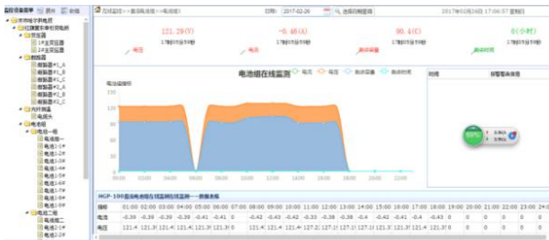
直流电池组运行状态在线监测
