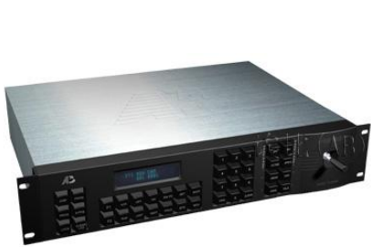
矩阵切换控制系统
